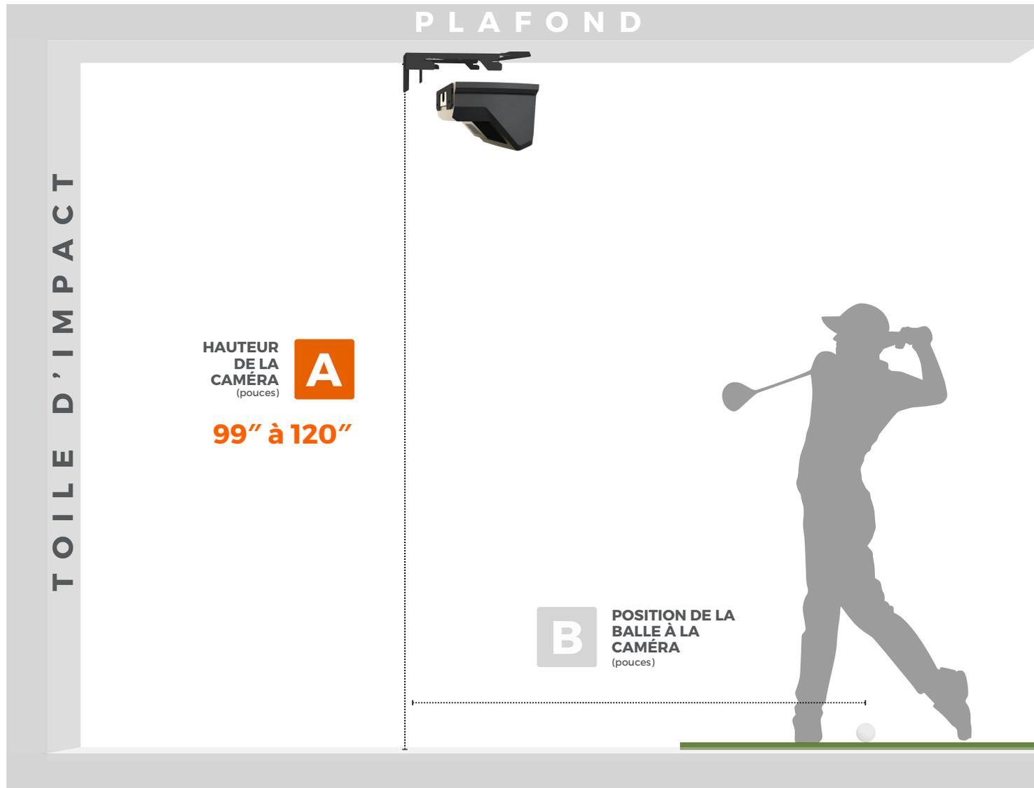
**B EST MESURÉ DEPUIS L'ARRIÈRE DE LA PLAQUE DE MONTAGE JUSQU'À LA POSITION DE LA BALLE.**
